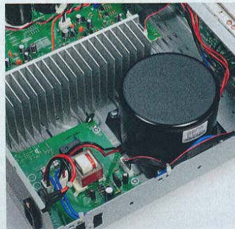
Aufwand in der Einstiegsklasse: HDAM-Ausgangsstufen aus Einzeltransistoren im Player (links), großer, gekapselter Ringkerntrafo im Vollverstärker
